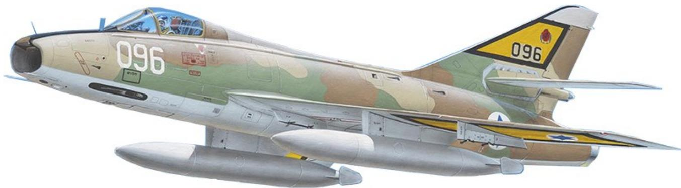
フランス・ダッソー社で開発された戦闘機で欧州初の実用超音速戦闘機でした。イスラエルには1958年から63年にかけて36機が導入され「サール」と名称され第三次中東戦争で実戦使用されました。その後エンジンをJ-52に換装しました。エンジン換装で後方排気口が延長されています。第四次中東戦争に投入され1975年まで一線で運用されました。
