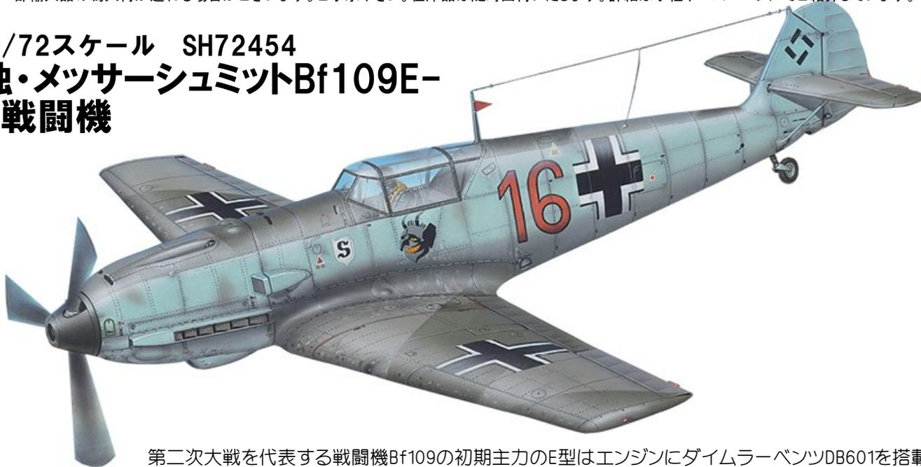
第二次大戦を代表する戦闘機Bf109の初期主力のE型はエンジンにダイムラーベンツDB601を搭載したタイプです。E-1型は機首、主翼共に7.92mmMG17を4丁搭載した機銃武装タイプです。
