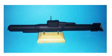
酸素魚雷を有人で操作する回天は様々なバリエーションが考案されました。 十型は九二式電池魚雷を利用したタイプで魚雷中央部に乗員用のスペースを挿入したタイプです。電池魚雷のため速力や射程は劣りますが、機関停止、 再起動が容易で逆転も可能など運用柔軟性が増しています。敗戦で試作の みが製造されました。
