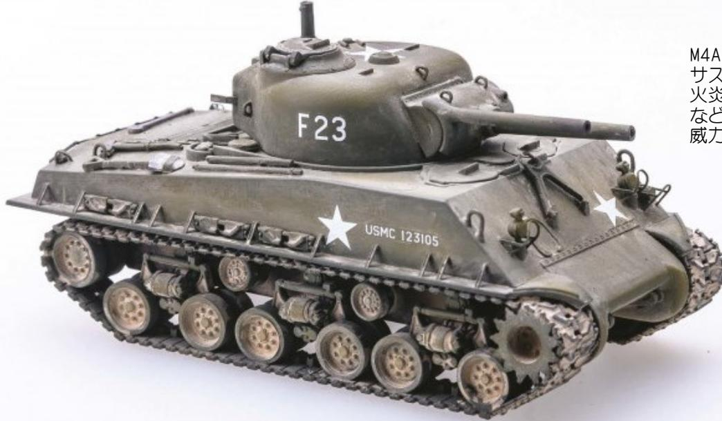
M4A3後期型車体に幅広のHVSSサスペンションを装備、砲塔には火炎放射機が搭載されトーチカなどの防御設備への近接攻撃に威力を発揮しました。
