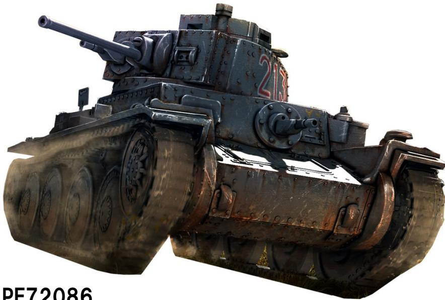
チェコのプラガ(CKD)社で開発された軽戦車です。シュコダのLTvz35が空気式操行装置の不具合が報告されたため堅実な方式で設計され信頼性を高めていました。ドイツのチェコ併合でドイツ軍用として接收され大戦初期にはドイツ軍主力として活躍しました。
