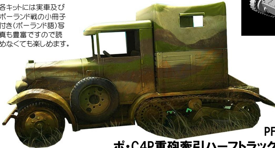
ポーランドでライセンス生産していたポルスキフィアット621トラックをベースにケグレス方式のハーフトラックを装着したタイプです。400両近くが生産され砲の牽引などに使用されました。荷室の短い短車体型は主に重砲の牽引に使用されました。
