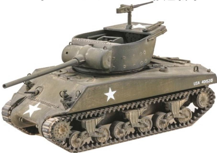
駆逐戦車M10はそれなりに成功した自走砲でしたがドイツ軍の重戦車<math>K</math>が登場し始めると威力不足と看做されるようになりました。そこでより強力な90mm砲を搭載する駆逐戦車が開発されました。M10の砲塔では90mm砲が搭載できないため新たに新型砲塔が開発されM36と命名されました。またM10車体だけでは需要が足りなかったためM4A3車体を使用するB1も開発生産されました。戦車車体なので車高は高くなりましたが装甲厚は戦車のままだったので防御力は向上しました。
