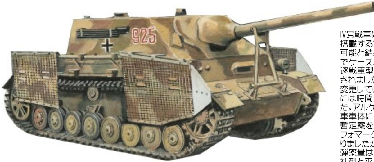
IV号戦車に70口径7.5cm戦車砲を搭載する計画は砲塔形式では不可能と結果が出ていました。そこでケースメート形式で搭載する駆逐戦車型がフォマーグ社で開発されました。しかし、車体を大幅に変更していたため他社での生産には時間がかかると予想されました。アルケット社では通常のIV号戦車車体にケースメートを搭載した暫定案を提出し採用されました。フォマーグ社よりも車高は高くなりましたが車内容積が広がり搭載弾薬量は増えました。フォマーグ社型と平行して生産され終戦まで使用されました。
