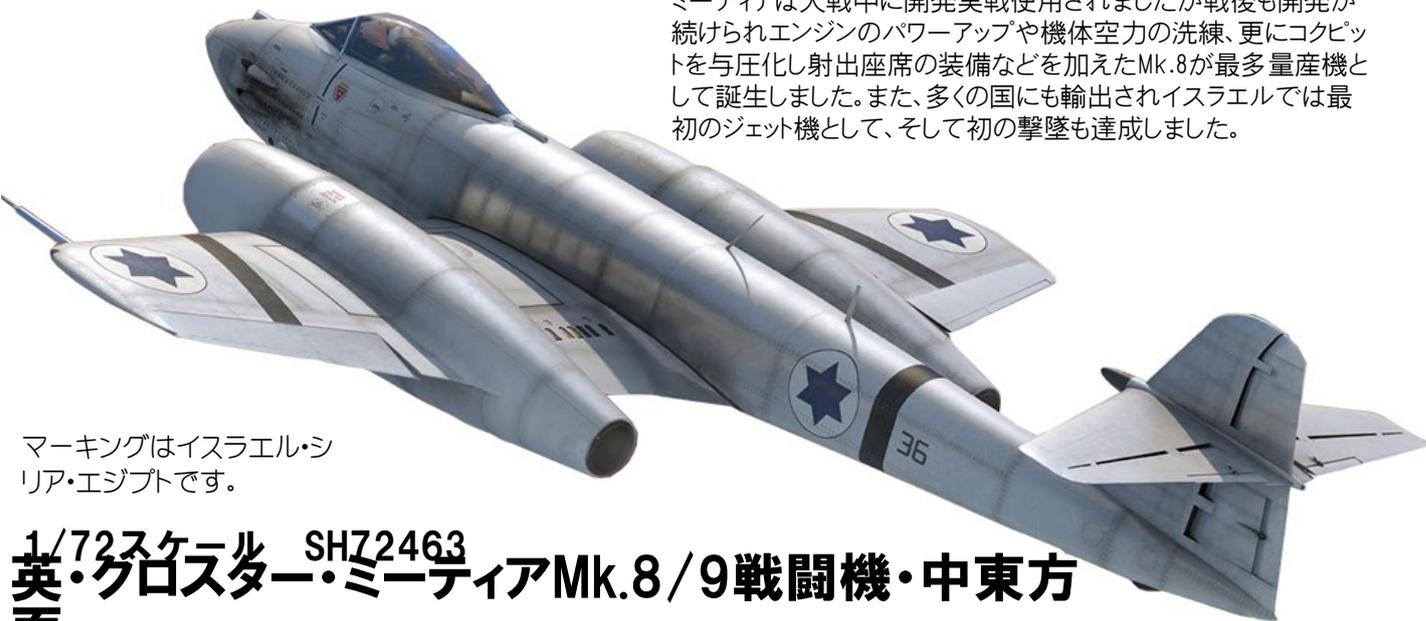
ミーティアは大戦中に開発実戦使用されましたが戦後も開発が続けられエンジンのパワーアップや機体空力の洗練、更にコックピットを与圧化し射出座席の装備などを加えたMk.8が最多量産機として誕生しました。また、多くの国にも輸出されイスラエルでは最初のジェット機として、そして初の撃墜も達成しました。
